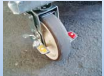
赤色ストッパー 回転ストッパー（ブレーキ） 黄色ストッパー 旋回ストッパー（首振り固定）
