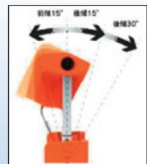
前倒15度、後倒15度と30度にヘッド角度が調整可能です。
