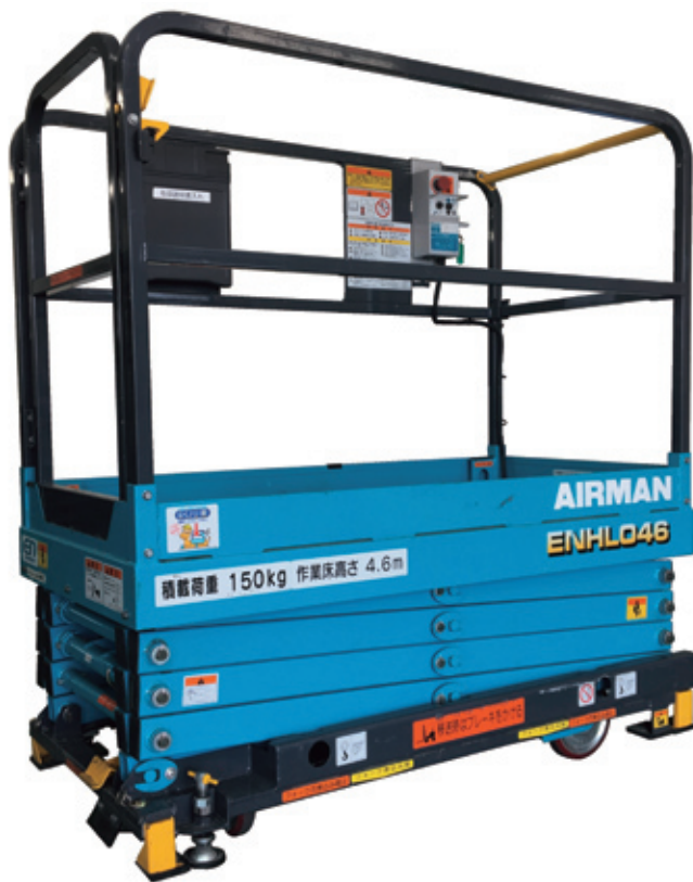
上昇時にアウトリガーが自動接地
