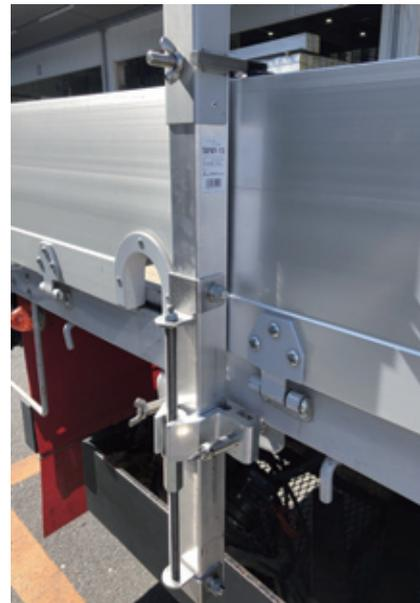
上部フックをあおりに引っ掛けて固定し、調整ナットでロックプレートを固定するだけで取付できます。
